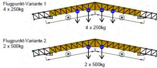
Die Nutzlast der Dachkassettenträger am Untergurt ist auf insgesamt 10kN = 1000kg zu begrenzen. Die maximale Anhängelast pro Dachbinderseite beträgt 500kg, diese kann variabel je Dachbinderseite verteilt werden. Der Anschlagpunkt hat dabei immer im Knotenpunkt zu erfolgen.
